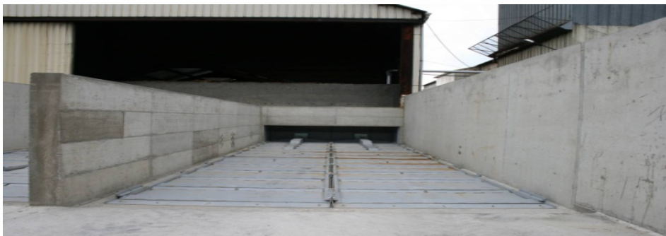
Транспортер накопичення і подачі палива
